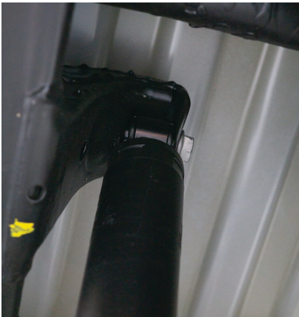
Fig. 24: Remove upper shock mount bolt.
