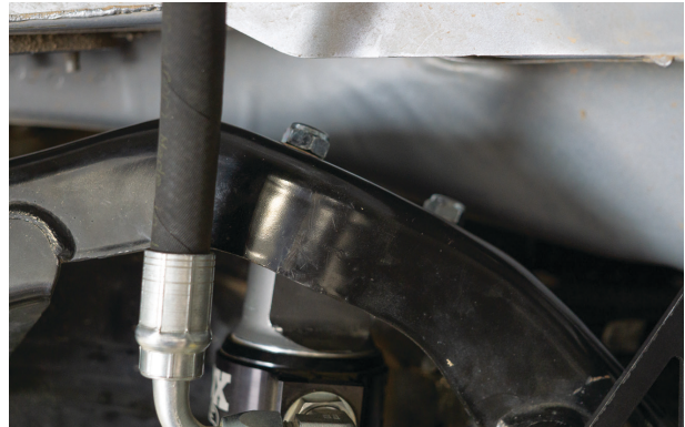
Fig. 33: Attach the top hat nuts.
