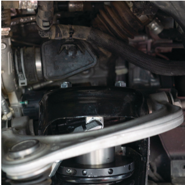
Fig. 14: Mount the top hat nuts.
