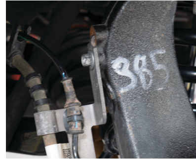
Fig. 21: Brake bracket bolt.
